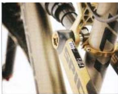
1_Fahrwerk: Die Einstellung des SAG erfolgt bei Lapierre bequem mit einem Monitor.
