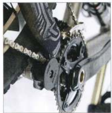
6_Kettenführung: Hier springt die Kette nicht vom Rad. Eine stabile Kettenführungsrolle hält sie an ihrem Platz.
