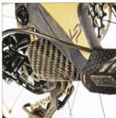
4_Schaltungsschutz: Pfiffig und wertvoll ist dieses kleine aber zu gleich wohl überlegte Bauteil.
