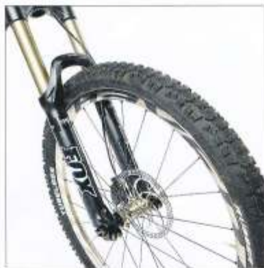
5_Laufrad: Easton Haven ermöglicht nach Bedarf Tubelessräder, wie den RubberQueen 2.2 UST.
