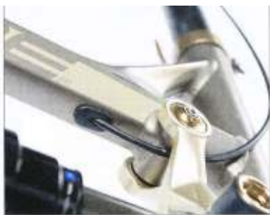
2_Leitungsführung: Die Leitung für die Variostütze läuft im Rahmen, die wichtigen Kabel leider unter dem Hauptrohr.
